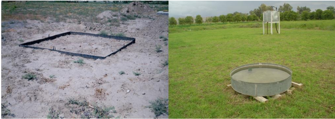
شکل ۲- لایسیمتر و تشتک تبخیر کلاس A نصب‌شده در آبخیز حاجی‌آباد هرمزگان.
