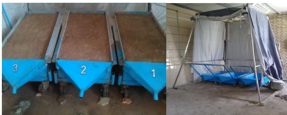
شکل ۲- شبیه‌ساز باران و کرت‌های فرسایشی.
