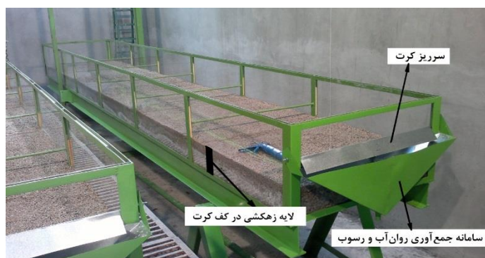
شکل ۱- نمایی از سامانه‌ی شبیه‌ساز باران و کرت‌های به کار رفته.
