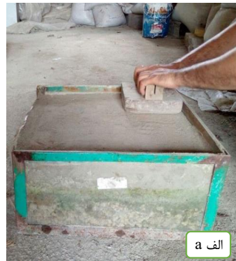
شکل ۲- آماده‌سازی خاک در کرت آزمایشگاهی (الف) و قرارگیری کرت‌ها برای اشباع خاک (ب).
