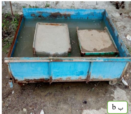
شکل ۲- آماده‌سازی خاک در کرت آزمایشگاهی (الف) و قرارگیری کرت‌ها برای اشباع خاک (ب).
