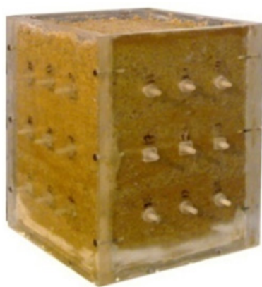
ج) نمونه‌ای از خاک متراکم شده در جعبه پلاستیکی شکل ۱- شماتیک و اجزاء مدل آزمایشگاهی ساخته‌شده
