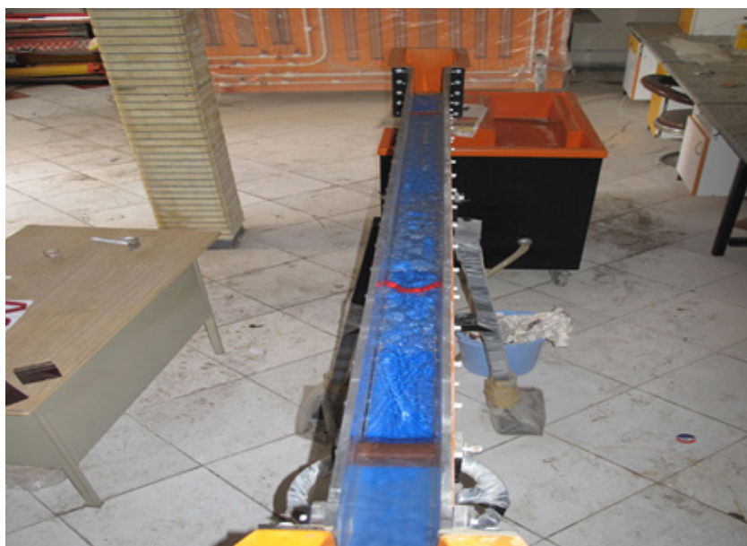
شکل (۶) تصویر فلوم و میز هیدرولیکی آزمایشگاه
